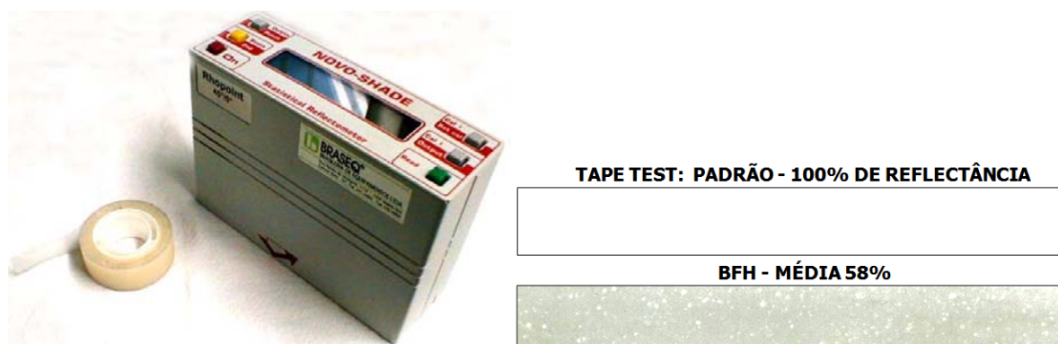
Figura 1. Ensaio de tape test : Aparelho e fita para medição do índice de reflectância (%).
