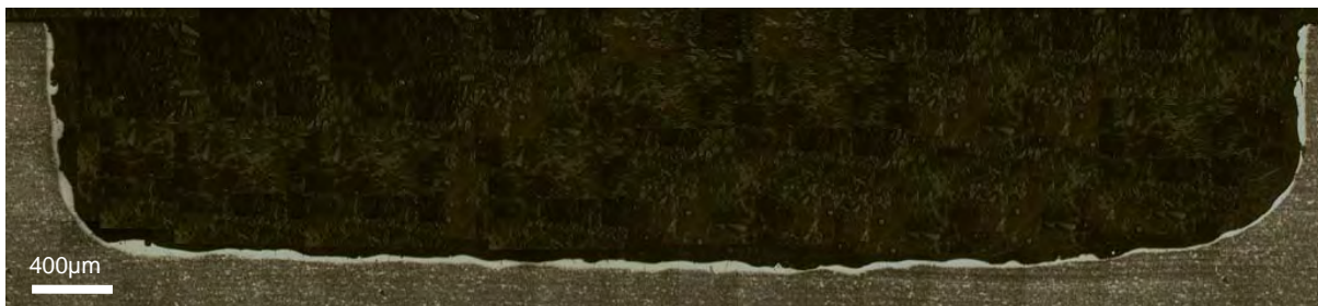
Figura 5. Imagens de microscopia ótica da seção transversal da cavidade usinada com óleo mineral sem pressão.
