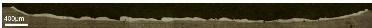
Figura 4. Imagens de microscopia ótica da seção transversal da cavidade usinada com água deionizada sem pressão.
