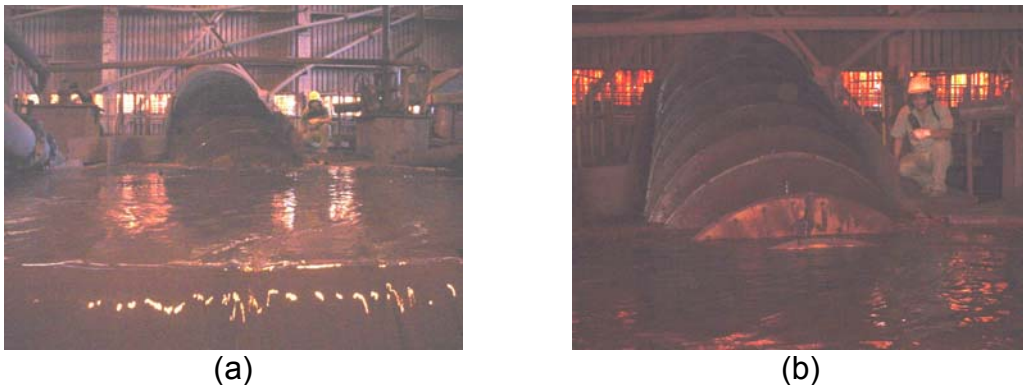
Figura 2. (a) Classificador espiral em operação. (b) Detalhe mostrando a espiral do classificador. Note o operador ao lado do classificador.
