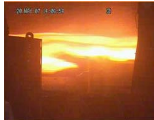
Figura 4 A . Estiramento no trem acabador. (6)
