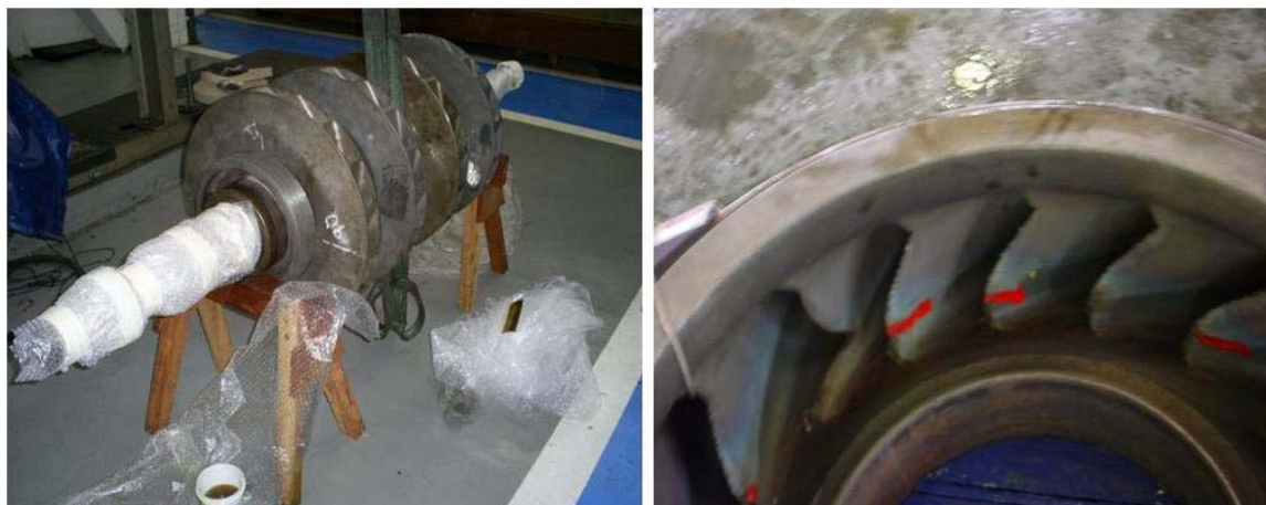
Figura 3. Detalhe do reparo do impelidor booster IHI-2.
