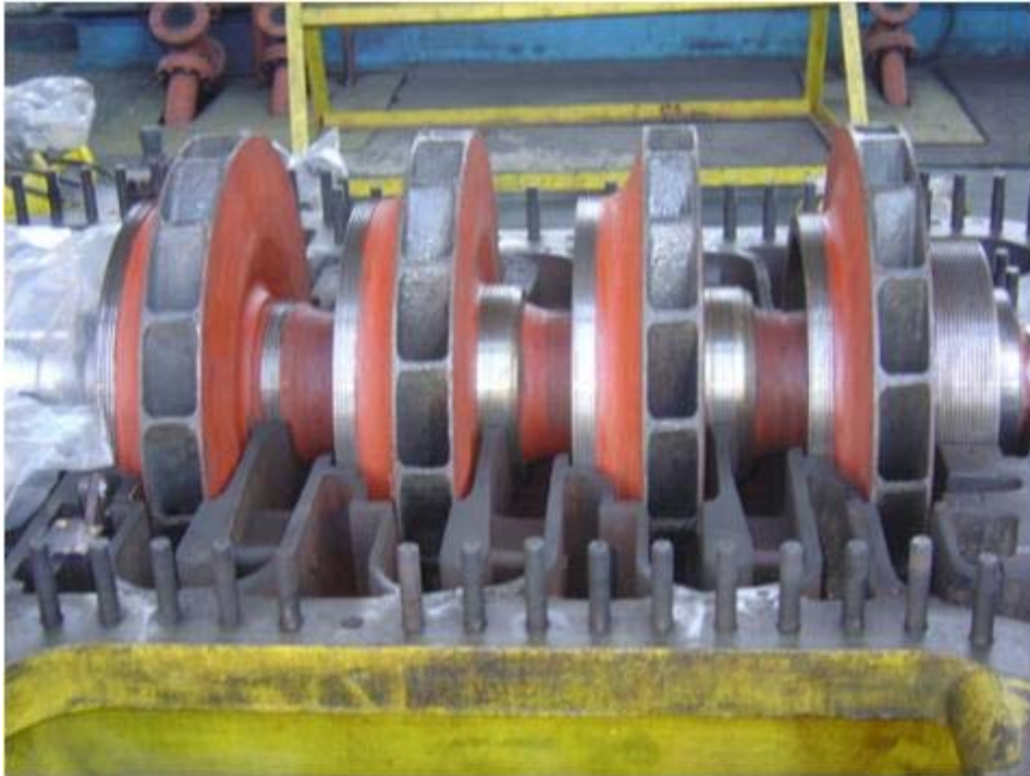
Figura 4. Detalhe de reparo do booster IHI-3.
