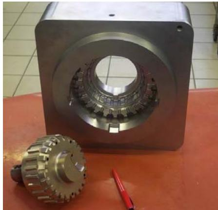
Figura 6. Molde e macho de injeção revestidos.
