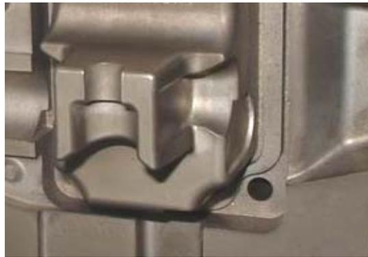
**Figura 4.** Trincas no molde.
