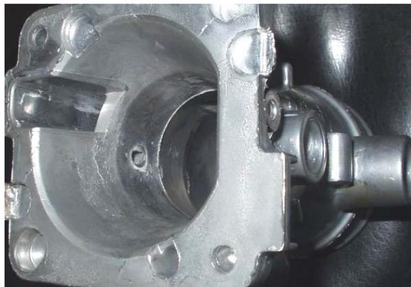
**Figura 5.** Defeito na peça injetada.
