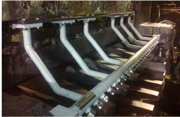
Figura 9. Novos coletores e bicos de refrigeração de cilindros.
