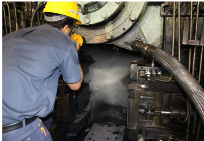
Figura 10. Rotina de inspeção diária da refrigeração.
