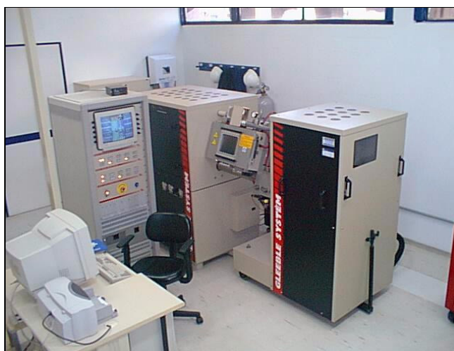
Figura 2. Foto do simulador termomecânico Gleeble 3500.
