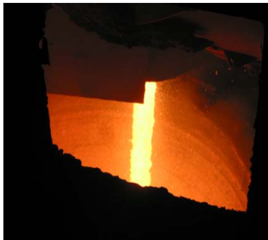
Figura 13: Fluxo de aço durante a corrida de vazamento número 142, conjunto de furos de corrida de teste Nº 5 com 1.850 mm de comprimento.
