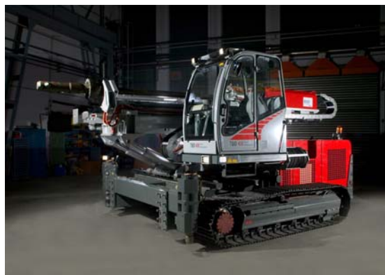
Figura 14: TBD 400 CSH sem a plataforma de trabalho instalada
