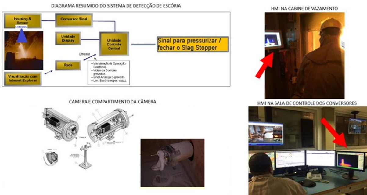
Figura 4: Sistema com câmera termográfica para detecção de escória
