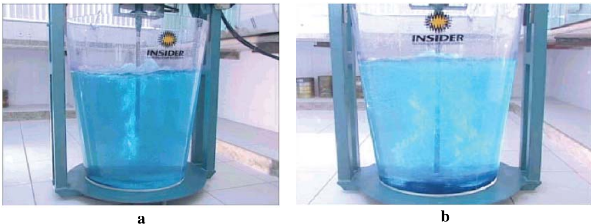
Figura 4: Dinâmica de agitação do banho contendo água no processo de simulação da dessulfuração do processo convencional contendo uma lança (a) e no processo SIRI com lança rotativa e furos laterais. (3)
