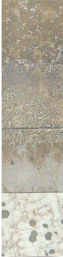
**Figura 6** Intercara acero rápido-fundición nodular- 50X.
