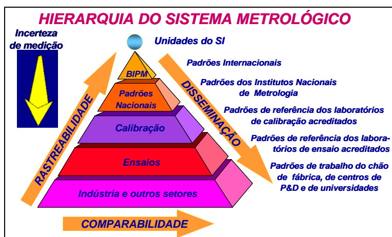
Figura 1. Cadeia de rastreabilidade de Dureza, que poderia ser aplicada a outra grandeza qualquer, mostrando o interrelacionamento entre rastreabilidade, comparabilidade, disseminação da confiabilidade nas medições e incerteza de medição. (6)
