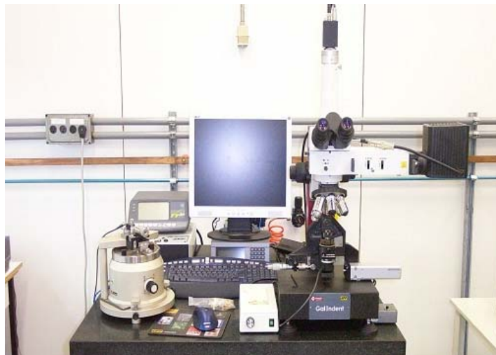
Figura 4. Sistema Primário para calibração de penetradores de Dureza Rockwell e Vickers do Inmetro (Gal-Indent).
