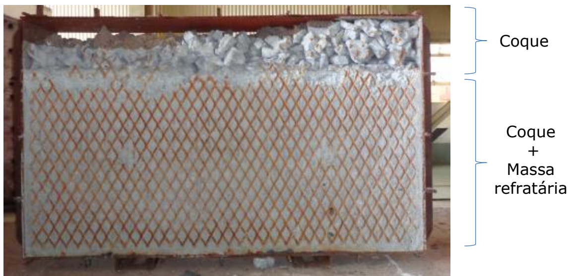
Figura 16. Fotografia da caixa metálica contendo coque após a injeção da massa refratária.
