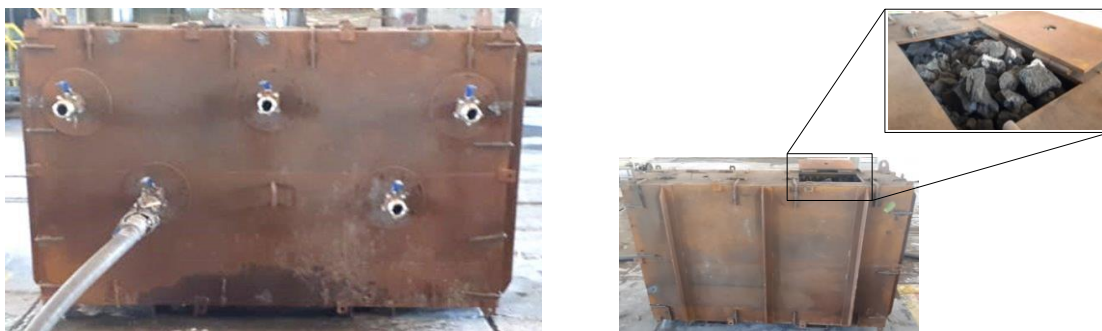
Figura 3. Fotografia da caixa de coque confeccionada para o teste de injeção.
