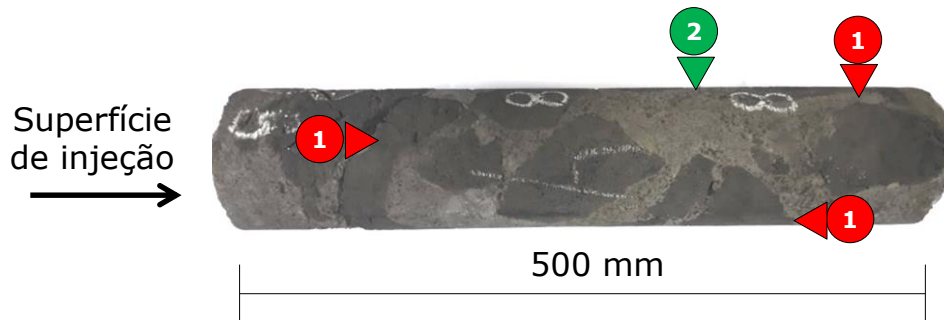
Figura 17. Fotografia do corpo de prova retirado na seção transversal da caixa de coque: (1) coque e (2) massa refratária.
