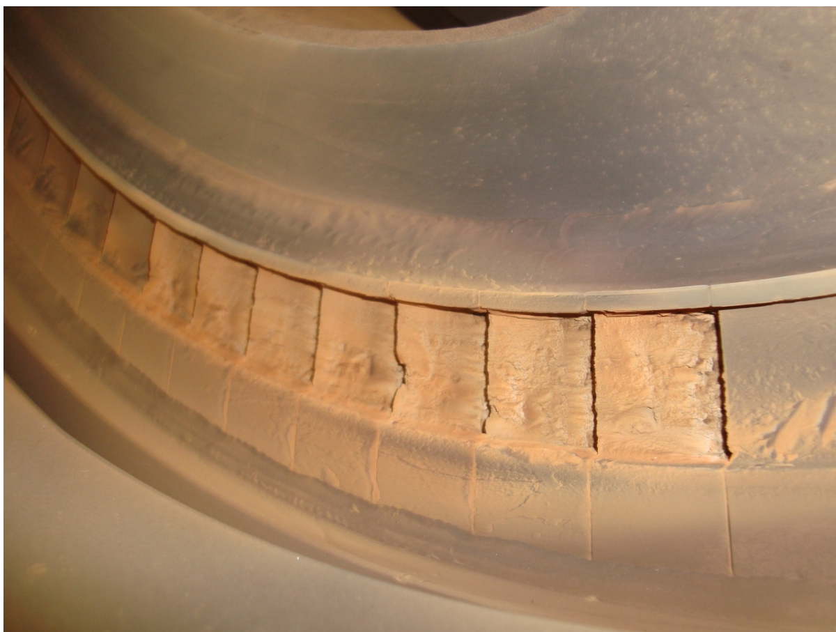
Figura 1. Injetor ou primeiro estator da turbina a vapor em análise.
