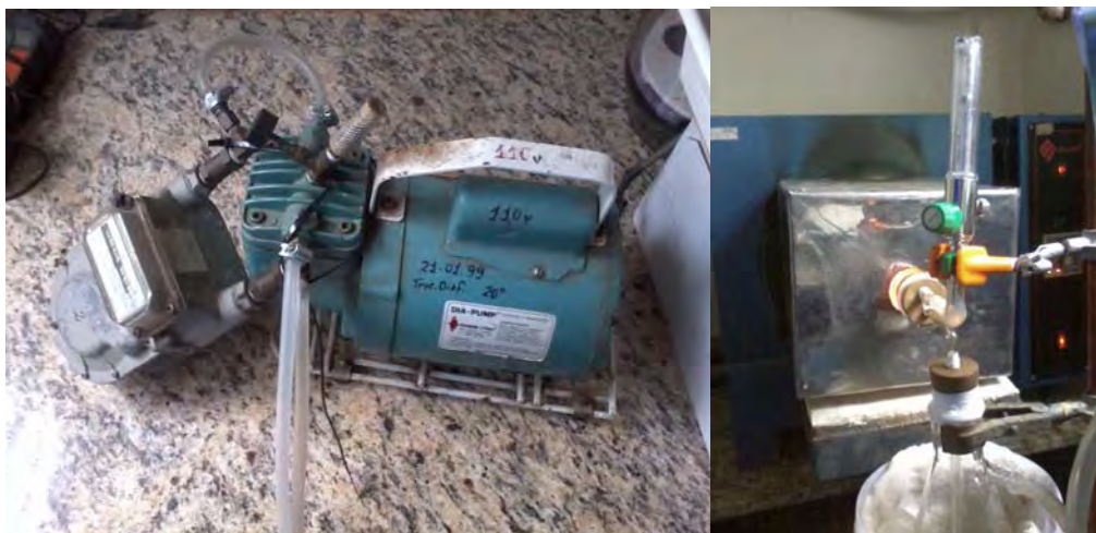
Figura 2. Da esquerda para direita: medidor de gás, bomba de vácuo e rotâmetro.
