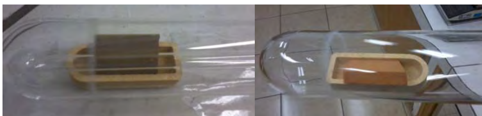
Figura 4. À esquerda amostra antes da queima, à direita, após a queima.
