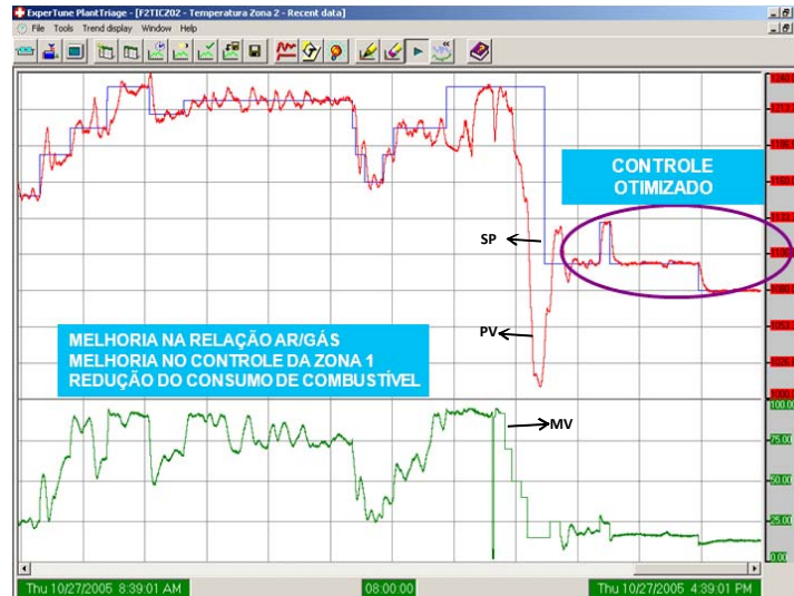
Figura 3 – Gráfico de tendência de uma malha de controle de temperatura em um forno siderúrgico.
