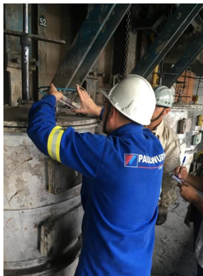
Figura 4. Medição da sucção nas caixas de fumaça.
