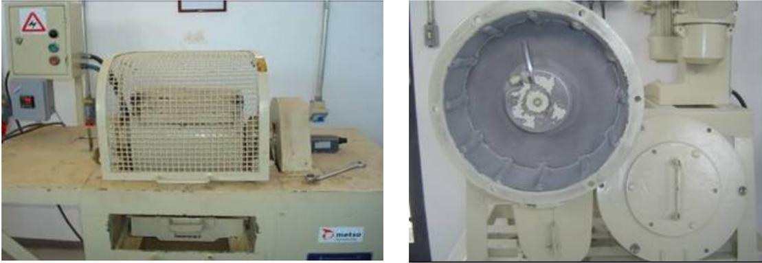
**Figura 3 – Esquerda:** moinho de bolas de Bond para determinação do work index. **Direita:** Equipamento utilizado no ensaio de bancada para determinação do índice de abrasividade.
