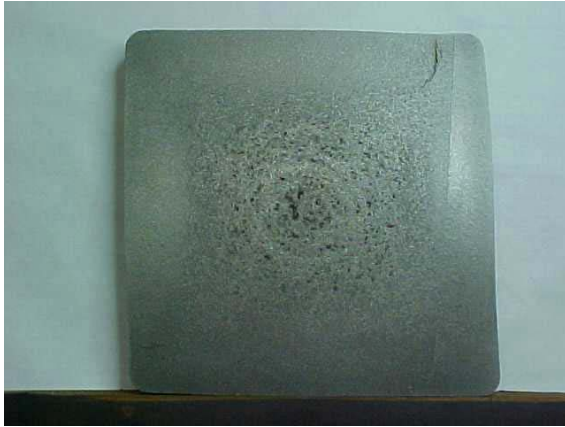
Figura 6. Macrografia do aço HNV3 apresentando trincas "off-corner"
