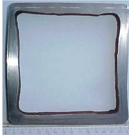
Figura 7. Corte de uma seção de um break-out mostrando a evolução não uniforme da casca solidificada.
