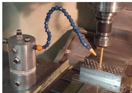
Figura 1: Processo de furação realizado com aplicação de MQF.
