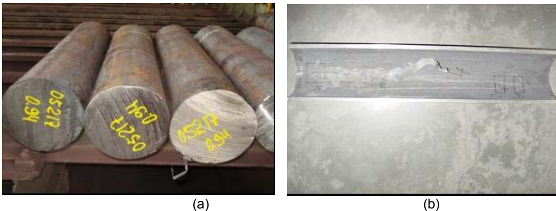
Figura 1 – (a) Blocos de barras lingotadas produzidos na MLC da V&M do BRASIL; (b) Dobra interna em um tubo laminado (meia-cana)
