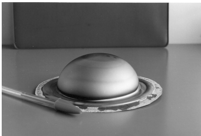
Figura 7. Exemplo de peça em liga de titânio moldada por conformação superplástica.
