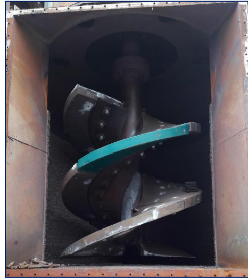
Figura 4. Revestimento helicoidal novo.
