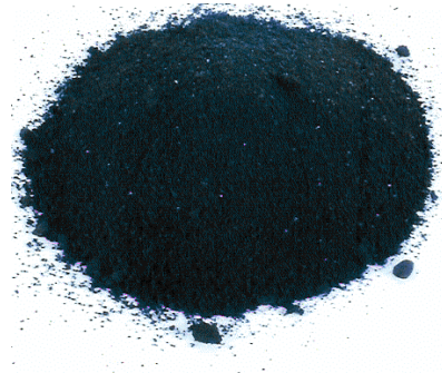
Figura 1: “Areia verde” de moldagem desagregada.
