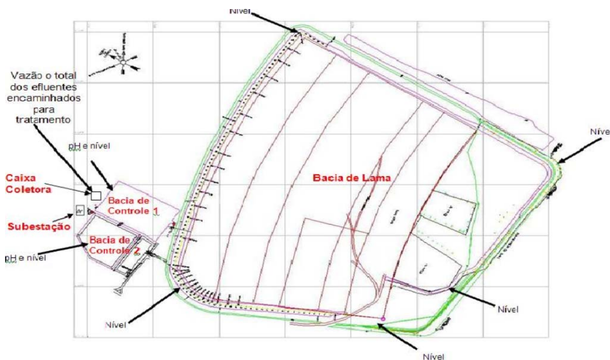
Figura 2. Esquema geral dos locais e variáveis que precisam ser monitorados no DRS.
