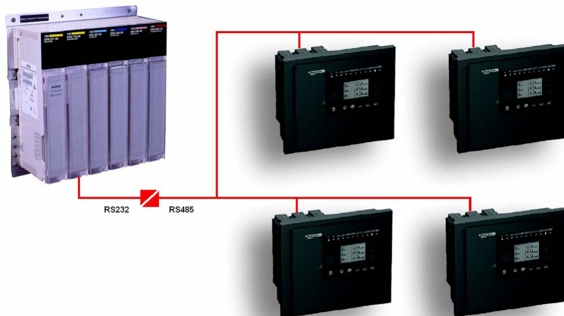
Figura 1 - Topologia da rede Modbus RTU em RS485 (2 fios) entre o PLC Schneider Modicon Quantum e os Relés Multifunção Microprocessados
