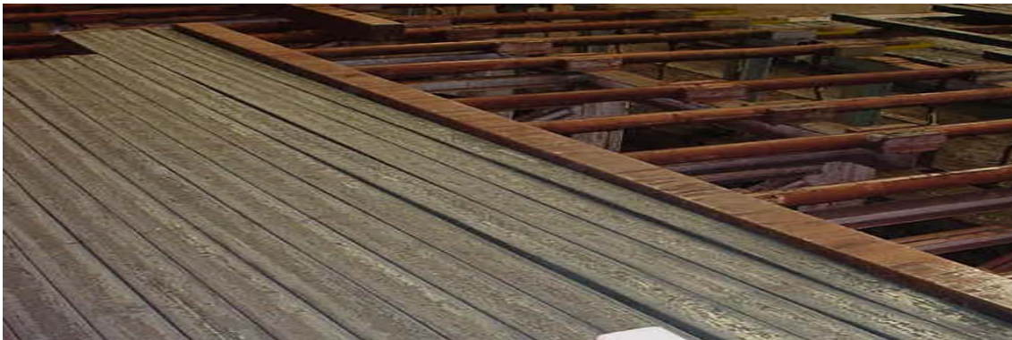
Figura 1 – Tarugos posicionados sobre o Leito de Resfriamento.
