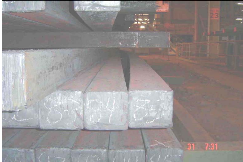
Figura 2 – Empeno causado por gradiente térmico.
