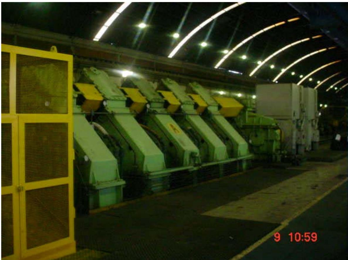
Figura 2. Foto física do bloco acabador
