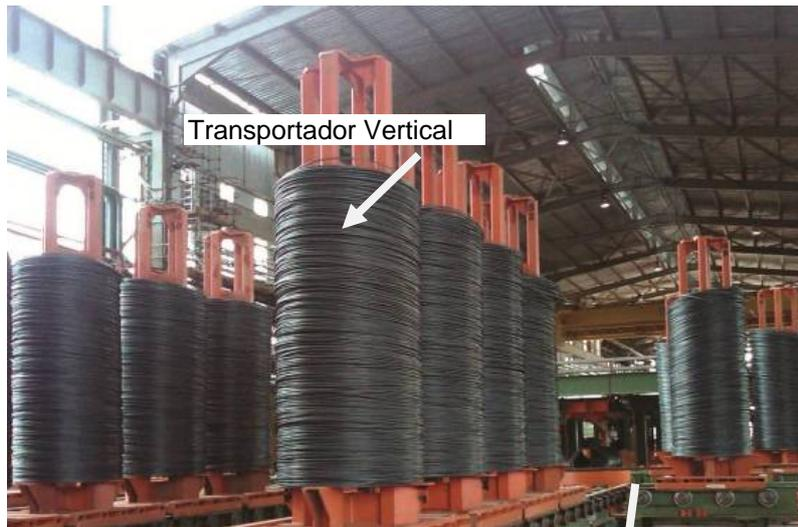
Figura 9. Transportador Vertical.
