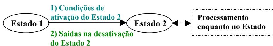
Figura 3 – Notação utilizada para construção do Diagrama de Estados
