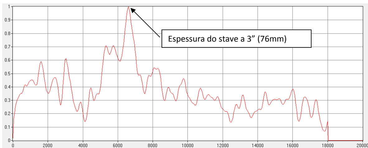
Figura 11. Dados de medição de espessura correspondente ao corpo do stave de cobre.
