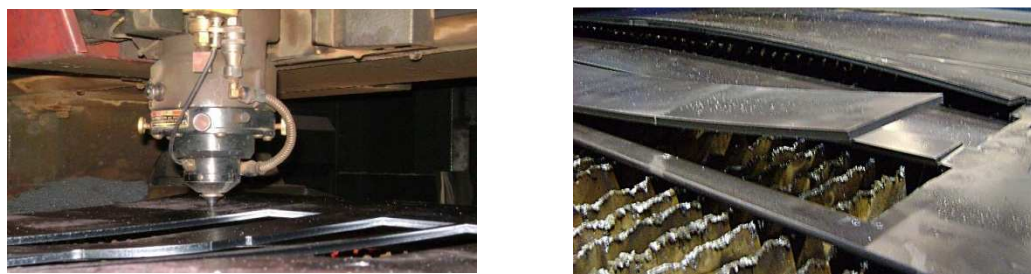
Figura 16 – (a) Cabeçote de máquina de corte a Laser encostando em uma peça que (b) está apresentando levantamento devido à tensão residual.
