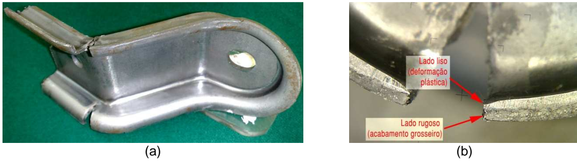
Figura 13 – (a) Peça automobilística que rompeu na conformação e (b) a indicação que o lado rugoso da peça estava localizado na região mais crítica (tração).
