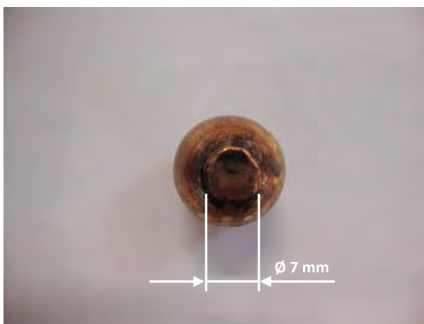
Figura 12. Eletrodo com 200 pontos e diâmetro da ponta com 7 mm.
