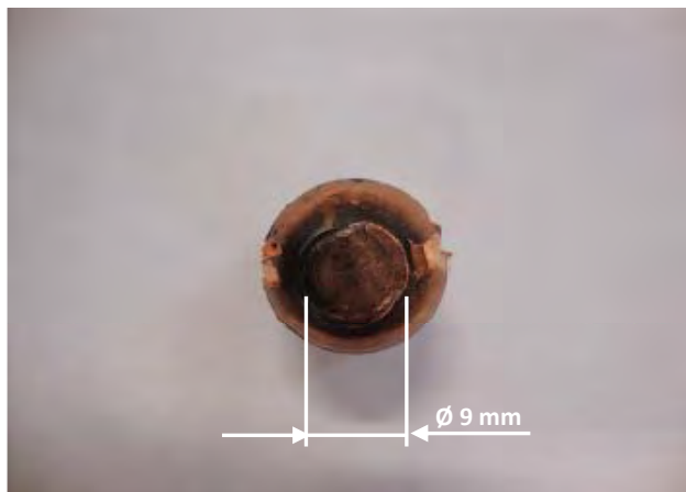
Figura 13. Eletrodo com 400 pontos e diâmetro da ponta com 9 mm.
