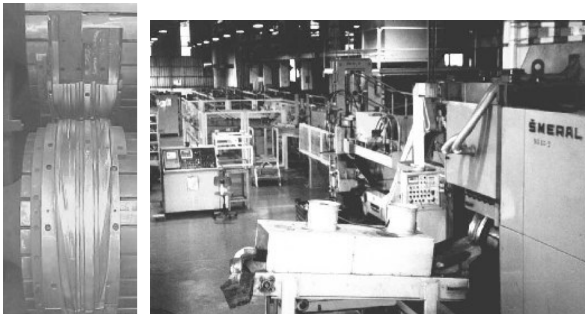
Figura 3: Montagem das ferramentas sobre os rolos laminadores (à esquerda) e vista geral da célula de forjamento (à direita). [5]
