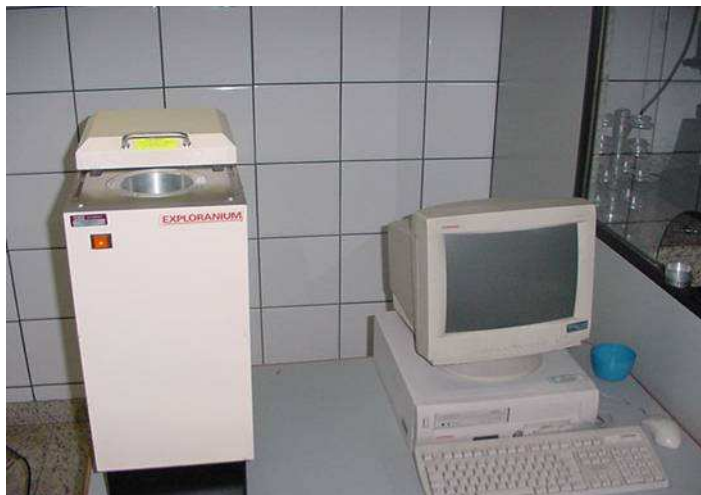
Figura 3 – GR-320, 3ª linha de defesa de monitoramento analisando as amostras de aço e escória.
