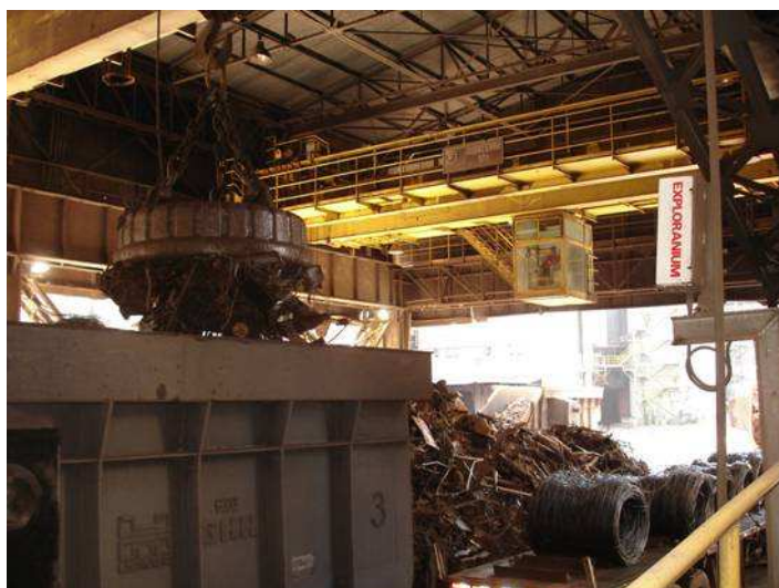
Figura 2 – AT-140, 2ª linha de defesa de monitoramento antes do enformamento de sucatas.
