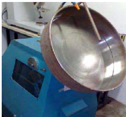
Figura 1. Disco pelletizador onde as pelotas foram produzidas no presente trabalho.
