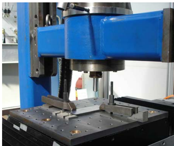
Figura 2. Vista do equipamento de deposição por fricção.
