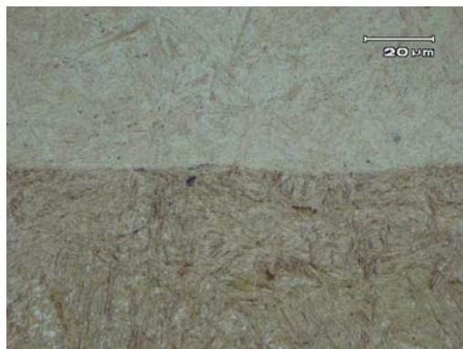
Figura 6. Micrografia em MO mostrando a região de interface entre o depósito do pino ABNT 4140 e o substrato.
