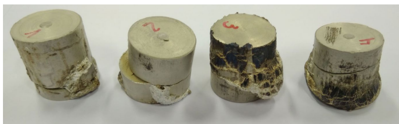
Figura 3 - Corpos nº 1, 2, 3 e 4 do Lote B após sinterização a 710°C.
