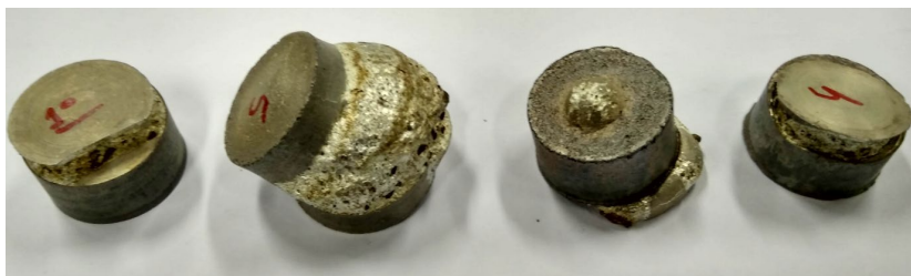
Figura 4 - Corpos nº 1, 5, 6 e 4 do Lote C após sinterização a 710°C.
