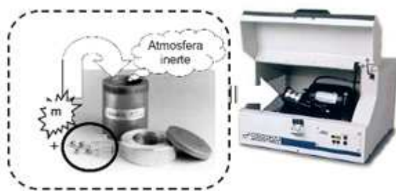
Figura 1. Esquema ilustrando os procedimentos adotados neste artigo para produzir nanopós por MAE. À esquerda, foto do recipiente de aço inox e bolas usadas para moer. À direita, foto do moinho de agitação de alta energia modelo SPEX 8000.
