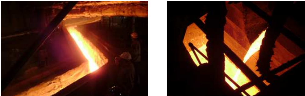
Figura 14: Vazamento da corrida da salamandra para blow down em março de 2009.
