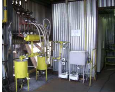
Figura 4: Sistema adicional de análise contínua dos gases do topo produzidos durante o abaixamento de carga.
