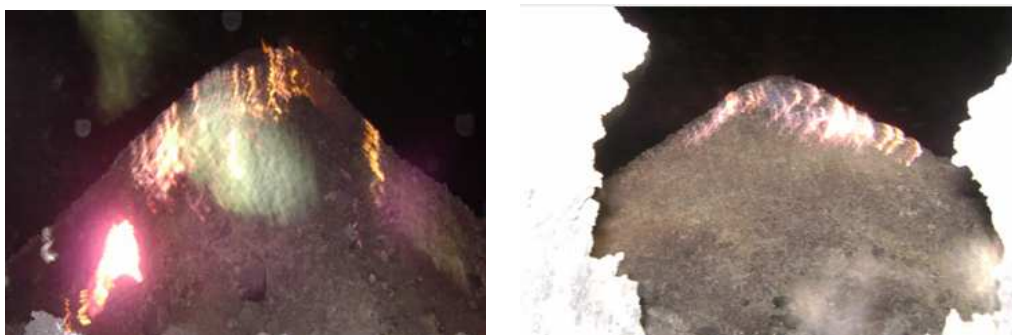
Figura 15: Fogo na carga em um mini Homem morto após blow down do AF2 em 2009.
