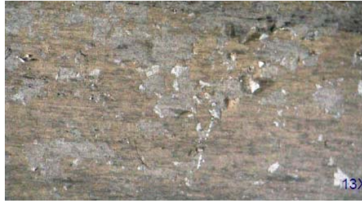
Figura 2. Zona problema con desprendimiento de superficie. Fotografía microscópica con aumento de 13X.
