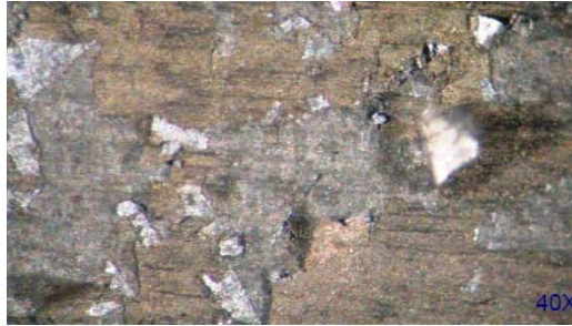
Figura 3. Zona problema con desprendimiento de superficie. Fotografía microscópica con aumento de 40X.
