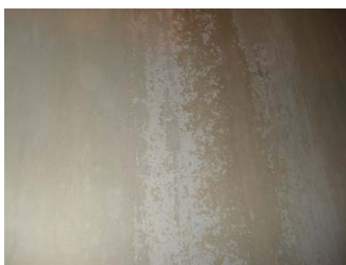
Figura 1. Patrón de defecto de suciedad superficial en acero eléctrico en salida de decapado.
