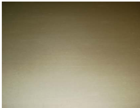
Figura 15. Acero eléctrico enrollado a 750°C después ser decapado a una velocidad de 200 m/min.
