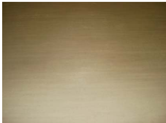
Figura 14. Acero eléctrico enrollado a 750°C después ser decapado a una velocidad de 230 m/min.
