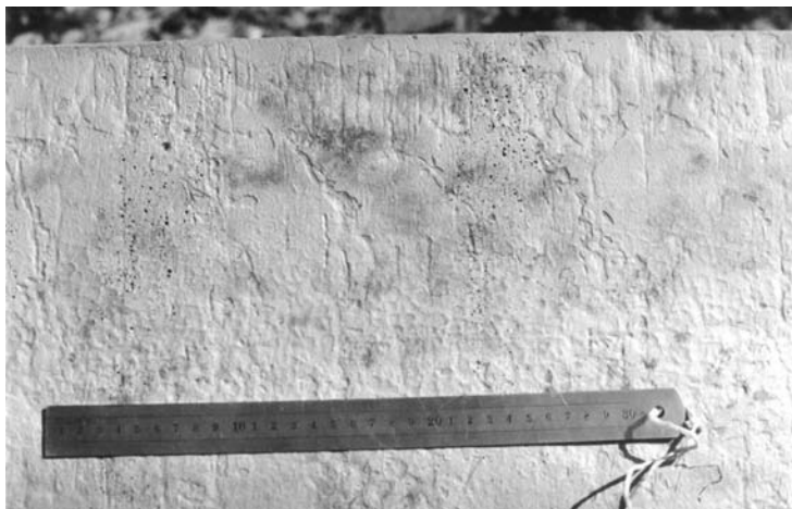
Figura 2. Aspecto dos pin-holes na superfície de um tarugo lingotado com azeite, previa limpeza com jato de areia. Neste caso, os “pin holes” estão distribuídos como nuvens transversais, que se repetem sobre a face ou faces envolvidas, seguindo um modelo cíclico, cada 10 cm.
