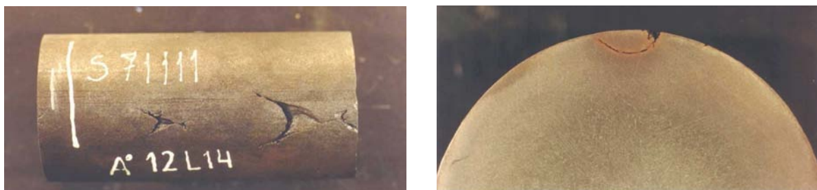
Figura 7. Evolução das trincas transversais durante a laminação, formando defeitos em V. Esquerda: aspecto de uma barra de aço de baixo carbono resulfurado a olho nu. Direita: corte transversal polido e macroatacadado da mesma barra.
