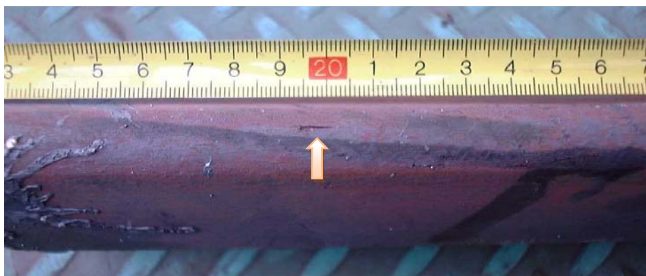
Figura 5. Alongamento do pin hole ao longo da laminação. Amostra tirada de cobre.
