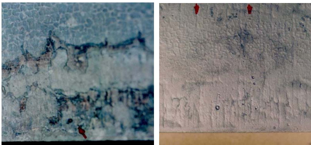
Figura 1. Aspecto de defeitos do tipo gota fria e pin holes em tarugo. Esquerda: sem limpeza; direita: após limpeza com jato de areia.
