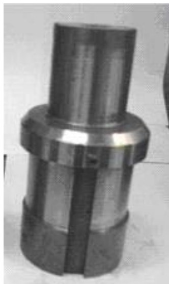
Figura 12: Ferramental bi-partido com sistema de fixação por rosca utilizado em prensa horizontal Hatebur AMP30 ® .
