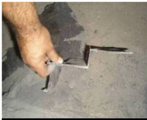
Figura 15 – Gusa retirado das gretas formadas entre os tijolos do fundo
