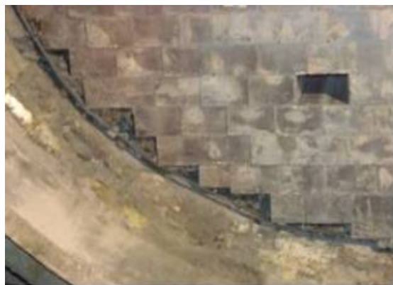
Figura 6 – Vazio na interface do fundo do convertedor.
