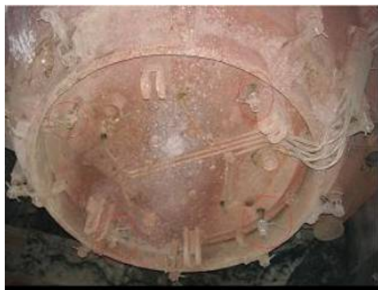
Figura 17 – Destaque dos pontos de adição adicionados no fundo do vaso.
