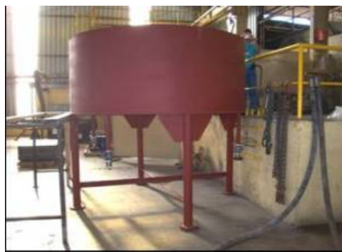
Figura 14 – Protótipo em metal para teste da injeção de massa.
