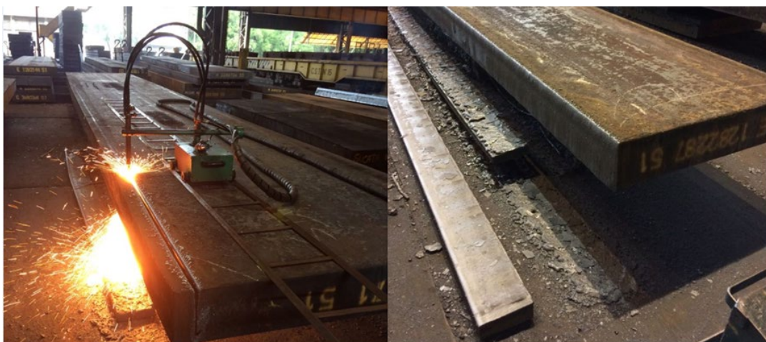
Figura 4. Eliminação do Defeito “Mudança de largura”
