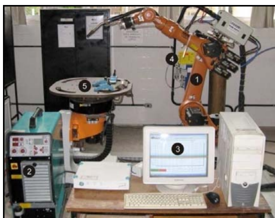
Figura 1. Equipamentos utilizados nas soldagens: (1) robô industrial com tocha e alimentador de arame-eletrodo, (2) fonte eletrônica multiprocesso, (3) Sistema de aquisição, (4) Medidor de Valim, (5) Mesa de trabalho.
