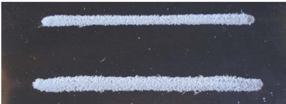
**Figura 16:** Comparação da erosão dos jatos, Scalemaster Superior em cima, Scalemaster HP em baixo.
