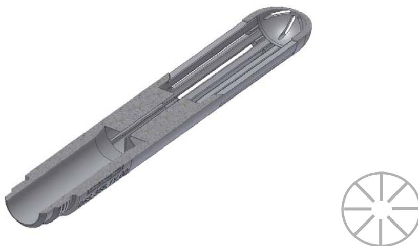
**Figura 6:** Unidade filtro/estabilizador sem miolo central da nova Scalemaster Superior.
