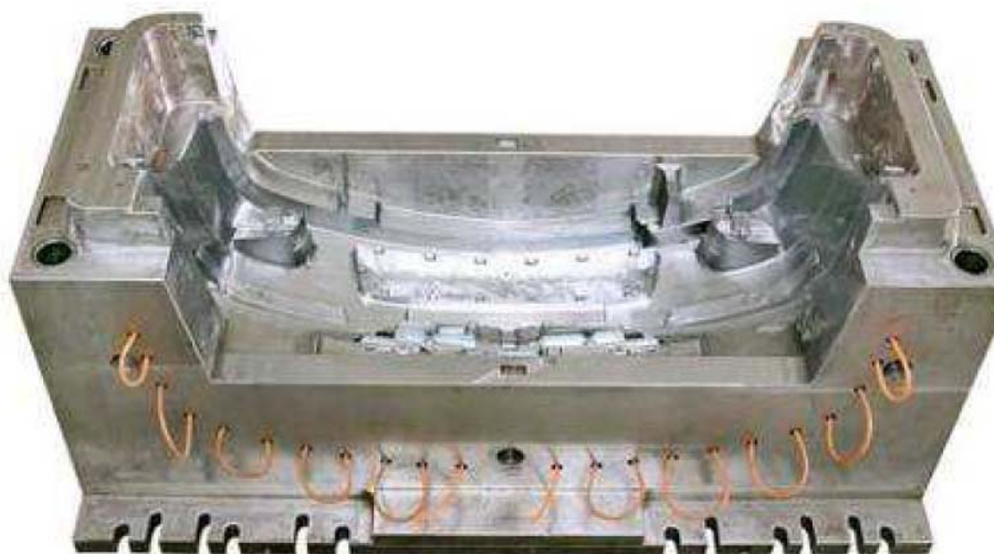
Figura 1. Molde para injeção de plástico de pára-choque automotivo. (5)
