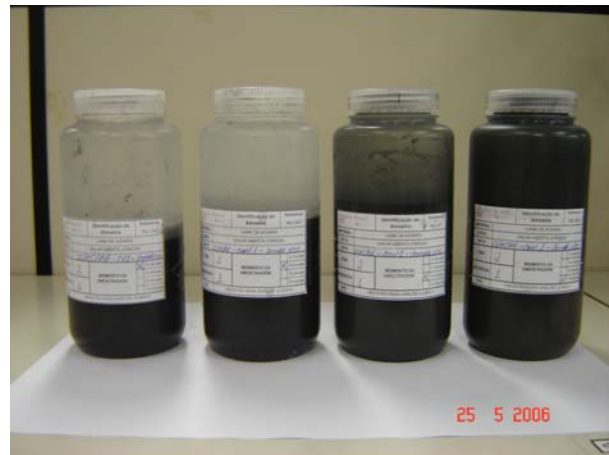
Figura 4: Amostragem na calha de aberta de retorno da água de lavagem dos gases
